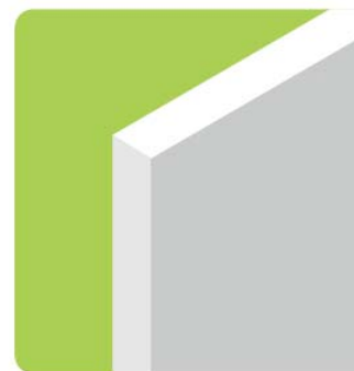
ソリッド構造 ・メラミン樹脂表面層とフェノール樹脂コア層を一体成形したパネル
