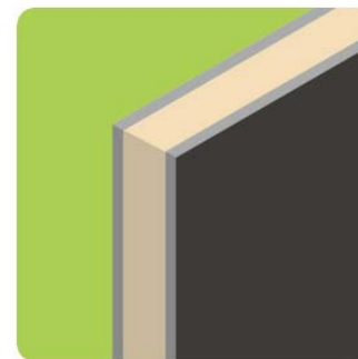
サンドイッチ構造 ・パネルが表面材と無垢芯材で構成された構造
