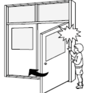
戸どうしが重なる面や、戸と枠のすき間に手を置かないでください。 巻き込まれてケガをするおそれがあります。
