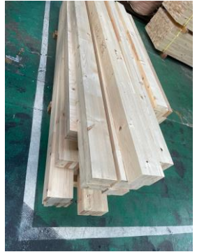
用途に応じて更に積層接着し柱等の角材に利用することもあります
