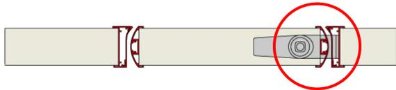
丸い形状のエッジを使用している場合は、中心吊のヒンジを使用します。
